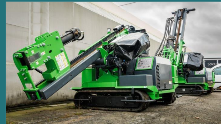
Maskinene som etablerer grunnfeste
