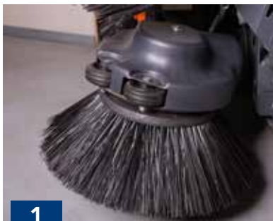
Spazzole anteriori protette da sistema di rientro antiurto. Front brushes protected by mechanical fuse.
