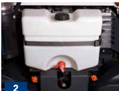
Sistema di abbattimento polveri con serbatoio acqua da 15 L Dust control system with 15 Lt water tank
