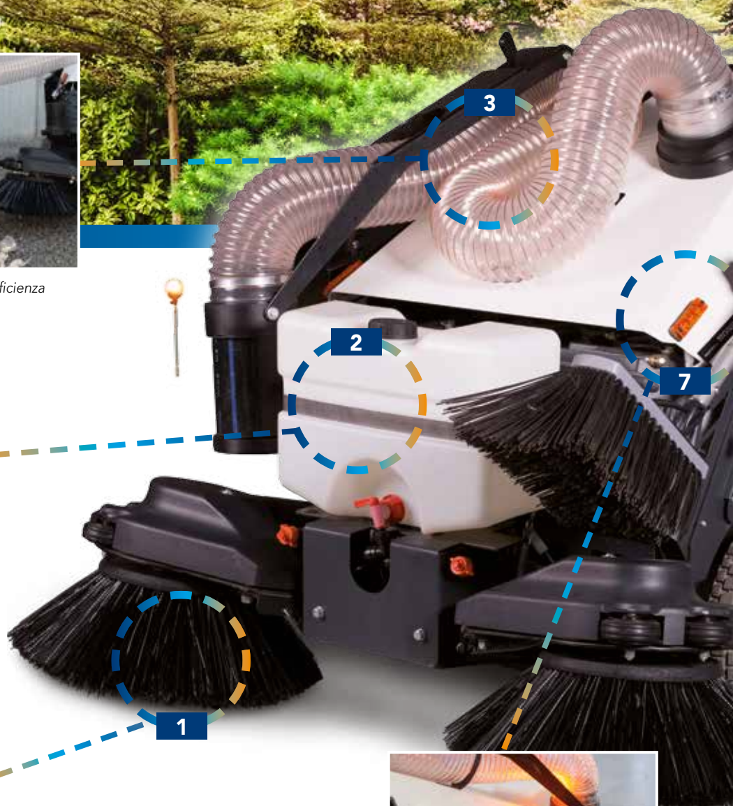
Sistema di abbattimento polveri con serbatoio acqua da 15 L Dust control system with 15 Lt water tank
