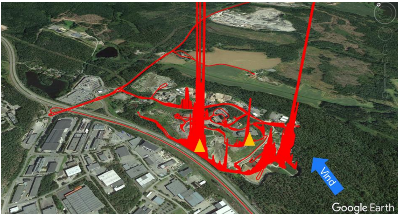
Figur 19. Kort over Solgård deponi. Rød markerer den relative metan koncentration over baggrunds-koncentrationen målt d. 22. november 2021 og giver et billede af, hvor metanen emitteres fra på måledagen. Gule trekkanter markerer, hvor sporgas flasker var placeret.
