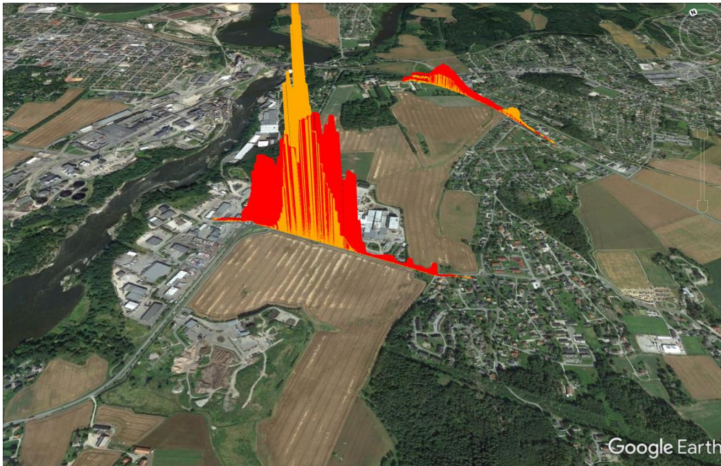
Figur 6. Metan- og sporgasfanen ca. 500 meter og ca. 1700 meter nedvinds fra Gatedalen deponi. Kvantificeringen er foretaget ved 1700 meter.
