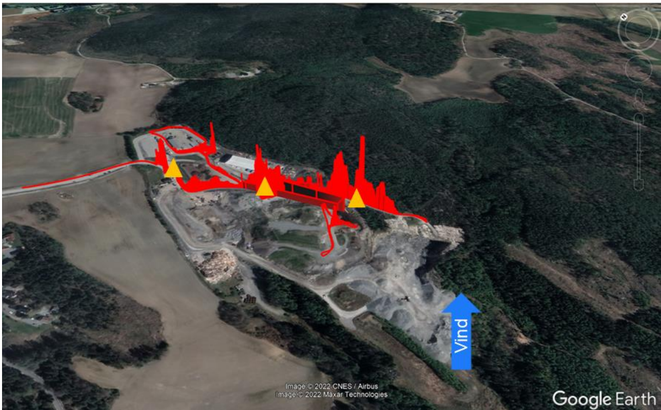
Figur 12. Kort over Rokke deponi. Rød markerer den relative metan koncentration over baggrundskoncentrationen målt d. 12. maj 2022 og giver et billede af, hvor metanen emitteres fra på måledagen. Gule trekantede markerer, hvor sporgas flasker var placeret.
