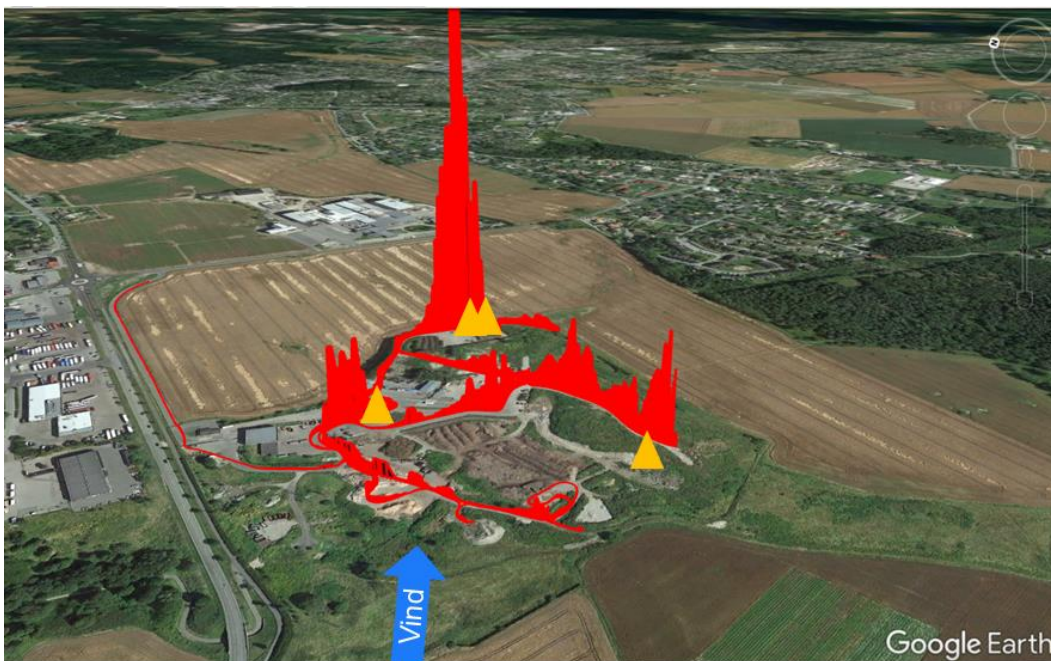
Figur 5. Kort over Gatedalen deponi. Rød markerer den relative metan koncentration over baggrundskoncentrationen målt d. 12. maj 2022 og giver et billede af, hvor metanen emitteres fra på måledagen. Gule trekantede markerer, hvor sporgas flasker var placeret.
